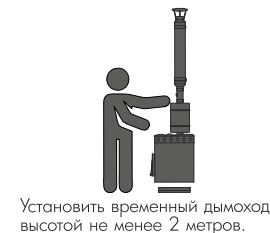
Установите печь (без камней) на огнестойкое основание на улице для первой протопки.
