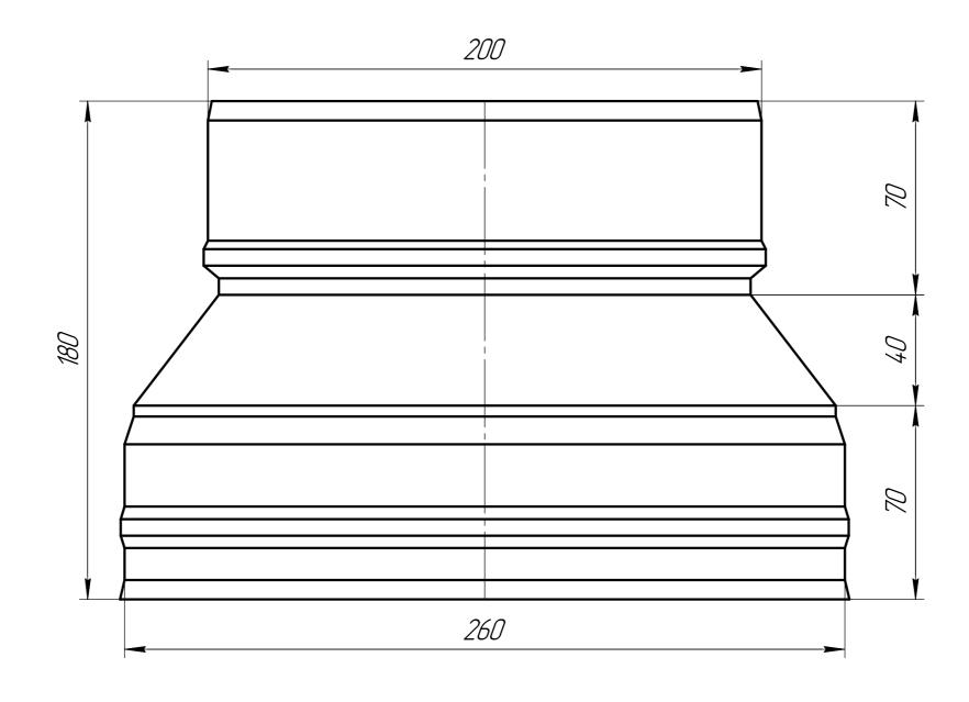
1. При сборке изделия, откатанные пояски конической детали, привариваются на внешней стороне обечайки составляющих частей. 2. По умолчанию первый размер переходника имеет расширение типа "мама".
